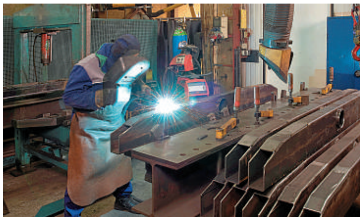
Beständige Verbindung: Viktor Polotzek beim MAG-Schweißen von Sicherheitsbauteilen.
